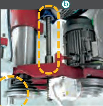
(b) Vite a ricircolo di sfere. (c) Albero di supporto al gruppo.
