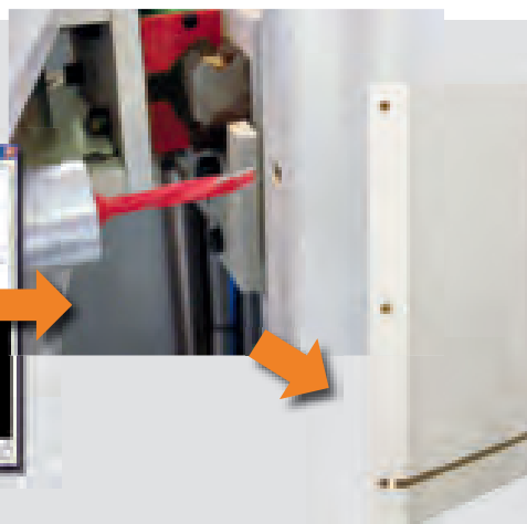
Foratura laterale e realizzazione della cava con lama Perçage latérale et rainure réalisés avec lame Agujero lateral y ranura realizada con disco
