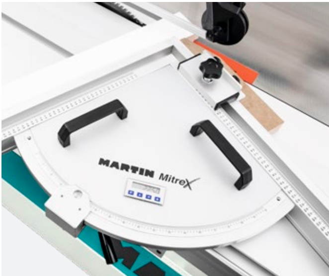
MitreX con indicación de ángulo digital | Txx79/2
