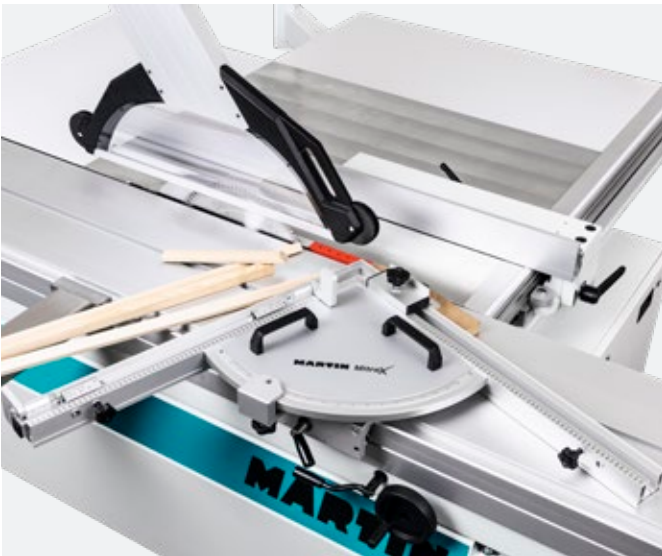
MitreX con indicación de ángulo analógica | Txx79/1
