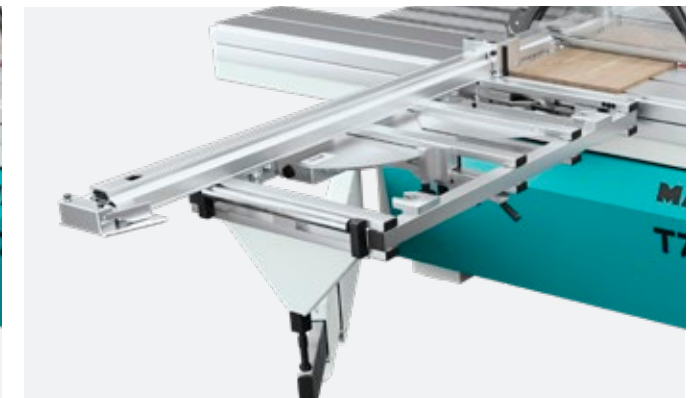
Tope longitudinal premium 2 puntos analógico | Txx72/1
