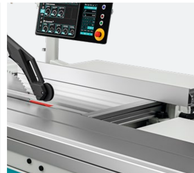
Tope paralelo T66 | T77 con visualización digital de la medida | Txx40/ 1
