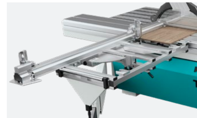
Tope longitudinal premium continuo digital | Txx73/2
