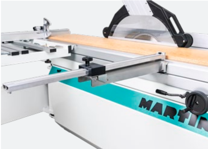
Tope paralelo para segundo apoyo | Txx82/ 1
