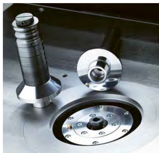
Sistema de sujeción del mandril portafresa HSK 63 F | Txx70_63F
