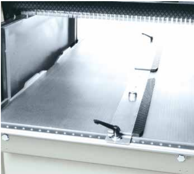
Segundo peine guía para trabajos de perfilado | T4541
